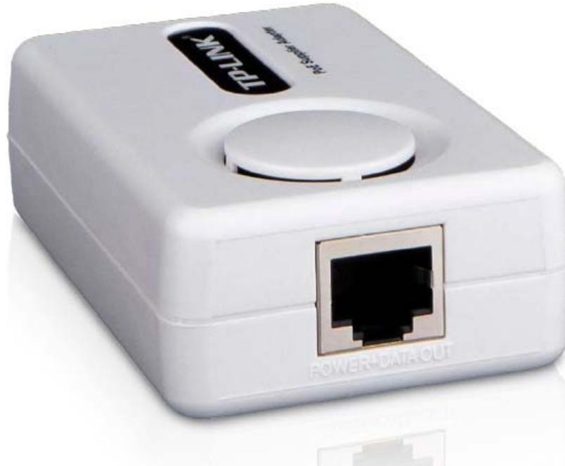
Proporciona energía eléctrica y datos a través del mismo cable hasta 100 metros
