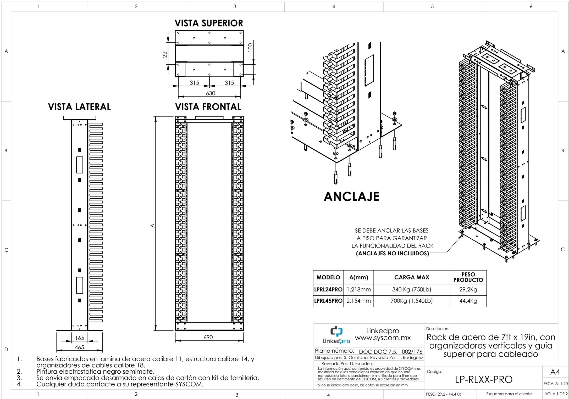
1. Bases fabricadas en lamina de acero calibre 11, estructura calibre 14, y organizadores de cables calibre 18.
