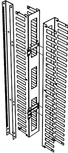
Para realizar una instalación doble, utilice solo 2 pares de tornillos y 1 par de brackets para sujetar ambos organizadores.
