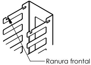
2- Instale los brackets de sujeción sobre las perforaciones preparadas en la parte trasera de su Rack de la serie EIRL o EIRA (no incluido) utilizando el kit de tornillos incluido.
