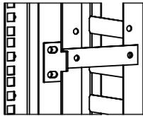
3.- Una vez haya distribuido su cableado de forma adecuada, coloque la puerta siguiendo los pasos como se indican en la imagen. Para retirar la tapa, primero retire la tapa del organizador superior y después el inferior.
