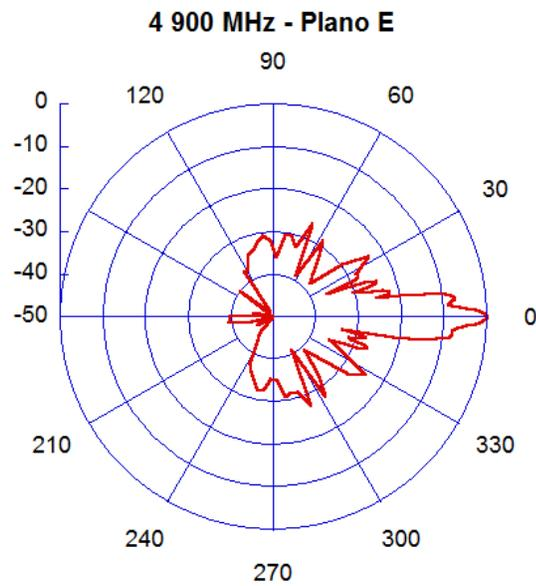
Figura 1. Diagrama de radiación. Frecuencia 4.9 GHz. Plano E.
