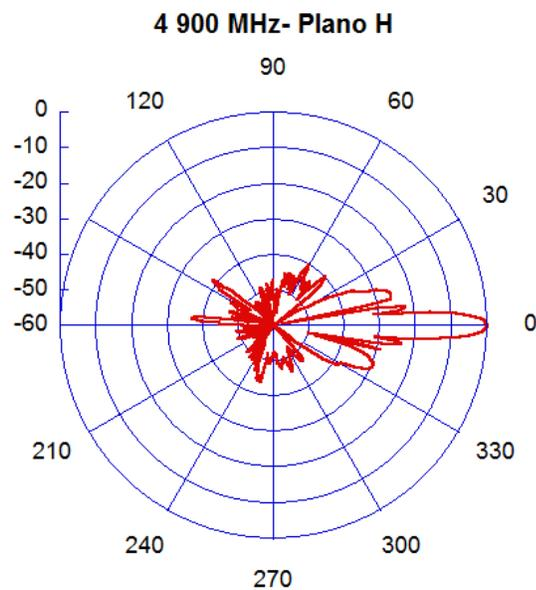
Figura 2. Diagrama de radiación. Frecuencia 4.9 GHz. Plano H.
