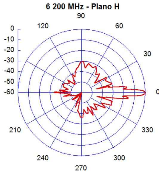
Figura 6. Diagrama de radiación. Frecuencia 6.2 GHz. Plano H.
