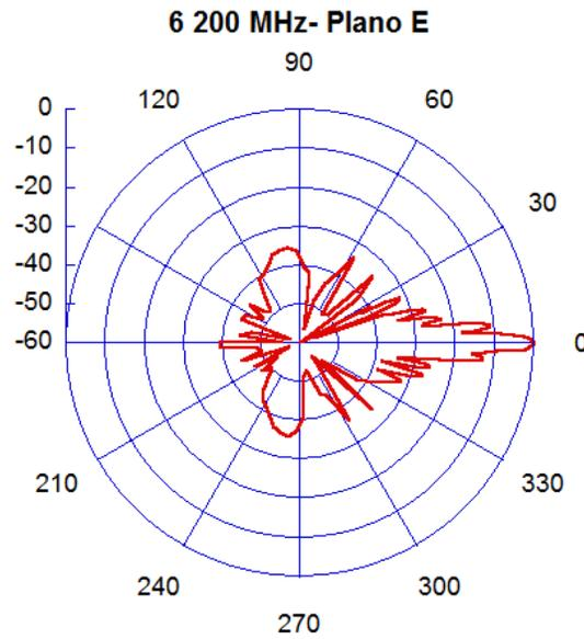
Figura 5. Diagrama de radiación. Frecuencia 6.2 GHz. Plano E.
