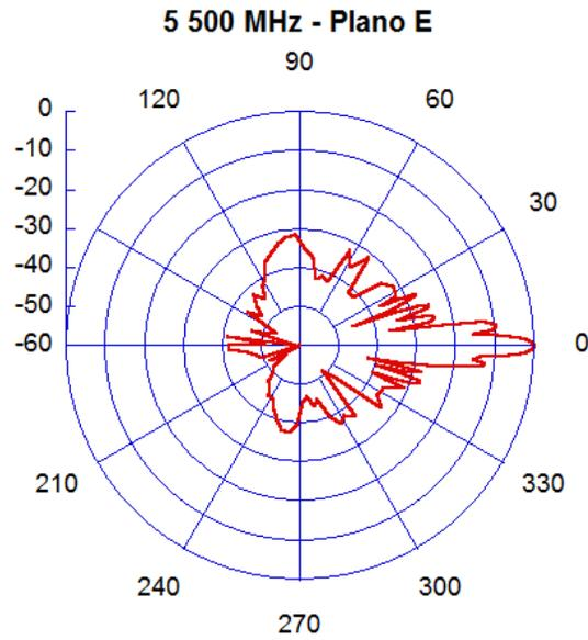
Figura 3. Diagrama de radiación. Frecuencia 5.5 GHz. Plano E.
