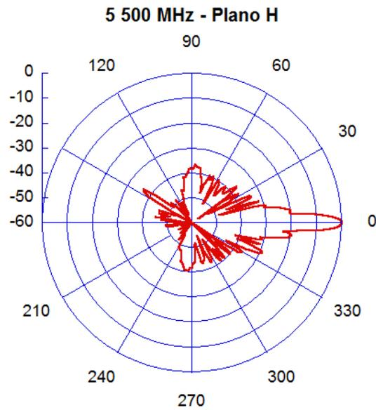
Figura 4. Diagrama de radiación. Frecuencia 5.5 GHz. Plano H.
